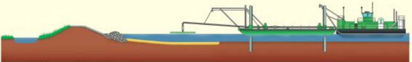
Stap 2: Aanbrengen 1 ste zandlaag van 0,50 cm.
