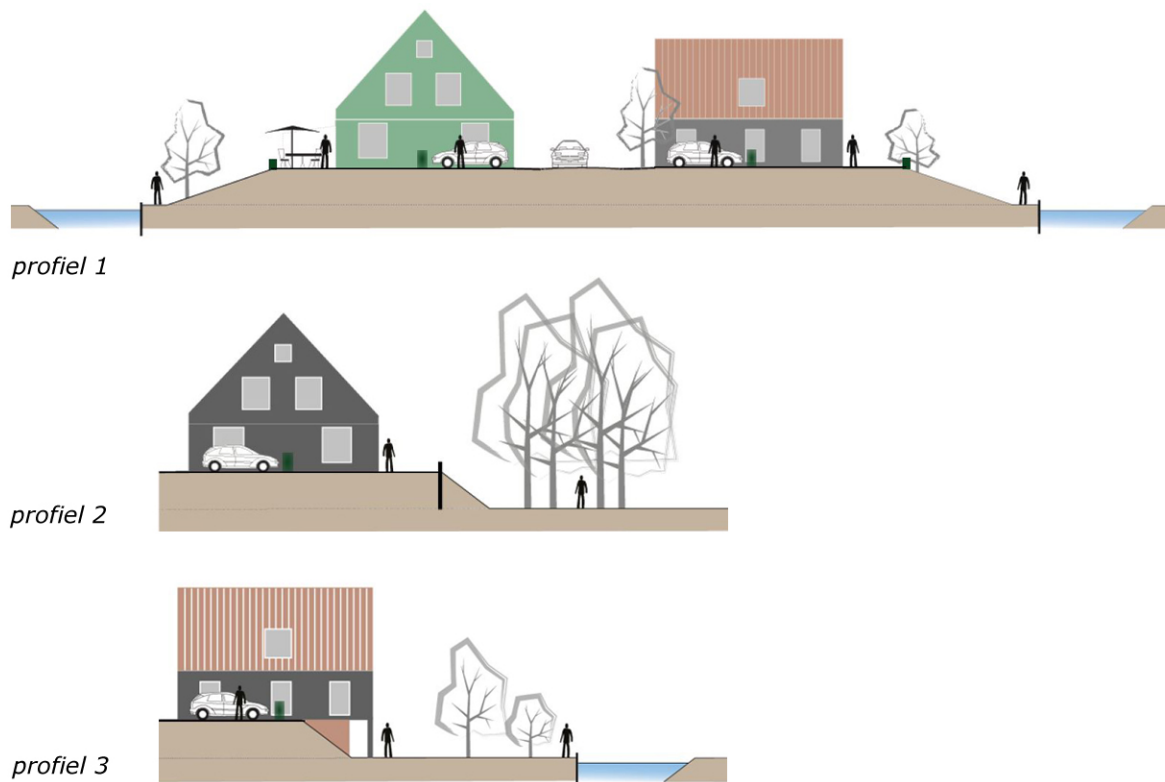
Figuur 3.8 - Doorsnedes taluds (bron: Stedenbouwkundig- en landschappelijk plan, Sweco)
