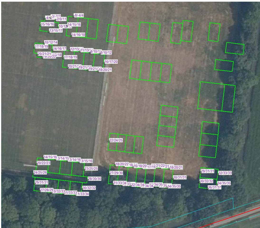
Figuur 4-2 Toetsingswaarde ( L_{den} ) in dB, door verkeer op het Oosterpad deelplan 2, inclusief aftrek conform artikel 3.4 uit het RMG 2012
