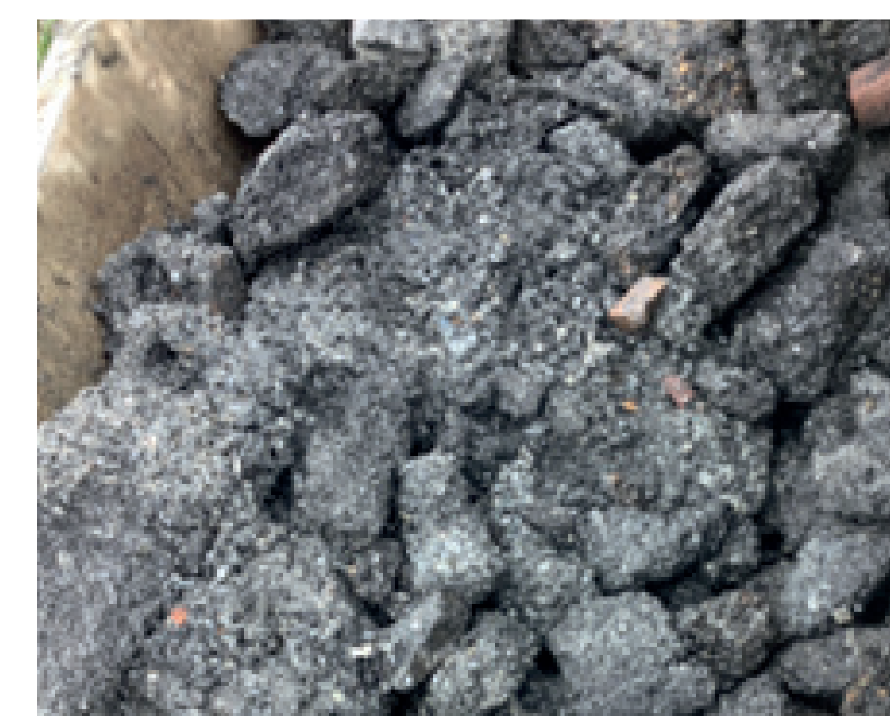
Voorbeeld asfalt- en gietasfalt in kreukelberm
